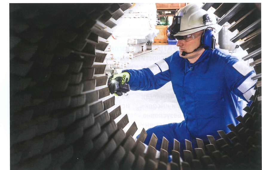
Рис. 3. Производственная площадка. Внесение информации в цифровую среду в процессе инспекционного контроля
